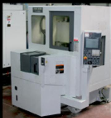
Après la préparation en interne de nos lopins (sciage, ébavurage, marquage...) la reprise d'usinage est réalisée sur tour C.N. avec robot de chargement ou sur Centre d'Usinage équipé de roto palette et de diviseur numérique.
